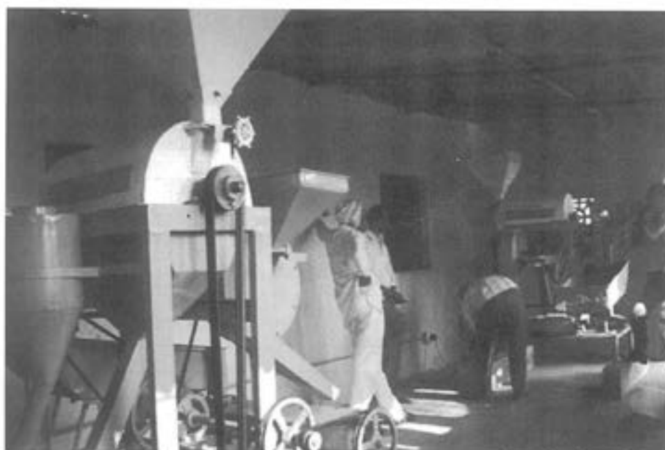
Plate 1 : Installation of PKV mini dal mill
